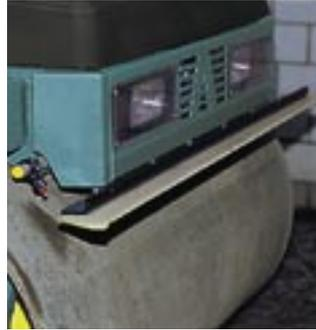
Klappbare Abstreifer mit Federvorspannung
